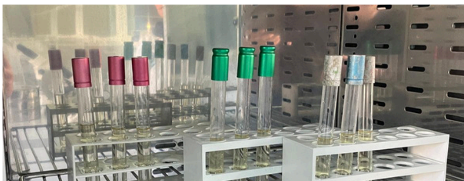
Campione lasciato in stufa per 24 ore a 42 gradi celsius
